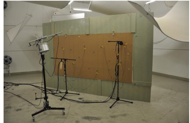
**Abbildung 2:** Messaufbau beim Hallraum-Verfahren, die Platte schwingt frei und ist von einem Baffle umgeben. Anregung hier mit einem elektro-dynamischen Shaker (direkte Methode), im Hintergrund Dodekaeder zur Anregung des Raumes (indirekte Methode). Vorne im Bild das verwendete Schalldruck-Mikrofon auf dem Drehgalgen.
